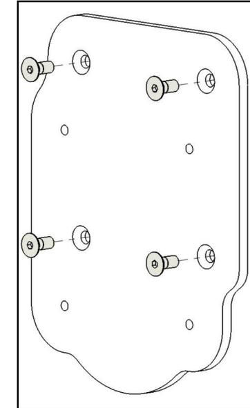
**Konsole für das EASY on Board WLAN-Interface**
